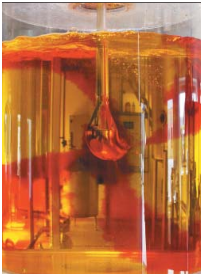
Figur 2. Væskeblanding, de 4 jetstråler fra mikseren ses tydeligt på billedet.
