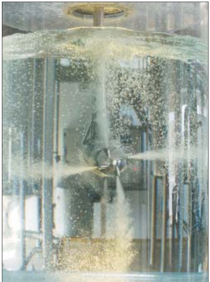
Figur 3. Luft/gas fordeling ved anvendelse af ISO-MIX teknologi.
