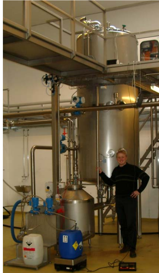
Abbildung 2: Thomas Grotkjær demonstriert den entwickelten Testreaktor in Ishøj. Der Tankdurchmesser beträgt 1,256 m. Das Standardtestvolumen beträgt 3,4m 3 . Das Flüssigkeitsvolumen der Rezirkulationsschleife beträgt 70 L und das Flüssigkeitsvolumen rezirkuliert zwischen 2 und 12 mal pro Stunde. Die zwei blauen Pumpen in der linken, unteren Bildhälfte sorgen für die optionale
