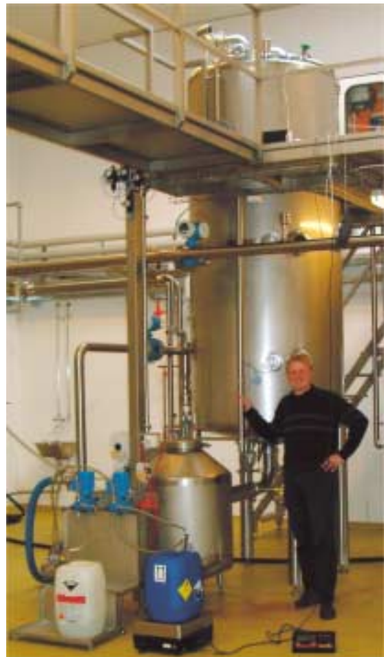
Figur 2. Thomas Grotkjær fremviser forsøgsanlægget, der er etableret i Ishøj. Tankens diameter er 1,256 m. Som standard blev der benyttet et væskevolumen på 3,4 \text{ m}^3 . Væskevolumenet i recirkulationssløjfen er 70 L, og hele væskevolumenet cirkuleres 2-12 gange i timen gennem recirkulationssløjfen. Der er via de to blå doseringspumper nederst til venstre i billedet mulighed for at sprøjte syre eller base ind i recirkulationssløjfen.
