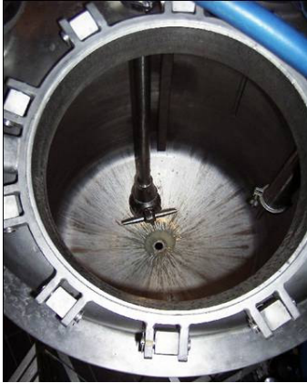
Fermenteringsreaktor med ISO-MIX blandehoved installeret.
